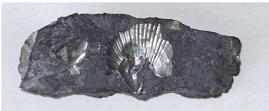
Рис. 5. Перекристалізації карбонатів раковин в алевроліті, підосва пласта т 3 Шахта ім. О.Ф. Засядька
