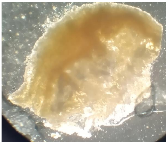
Рис. 5. Двоверхшні кристали і кристали що розщиплюються. Поляризоване прохідне світло
