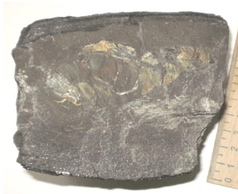
Рис. 1. Зразок підшви пласта m_3 (аргіліт з проявами піритизації) Шахта ім. О.Ф. Засядька
