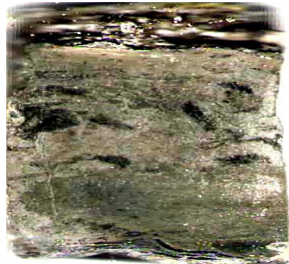
Рис. 2. Аншлиф зразка підшви пласта m_4^2 (пірит з незначними включеннями чорного аргіліту) ДП ВК «Краснолиманська»
