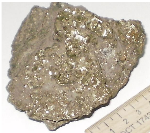
Рис. 3. Зразок підшви пласта m_0 (пісковик з кристалами піриту та халькопіриту) Шахта «Піонер»
